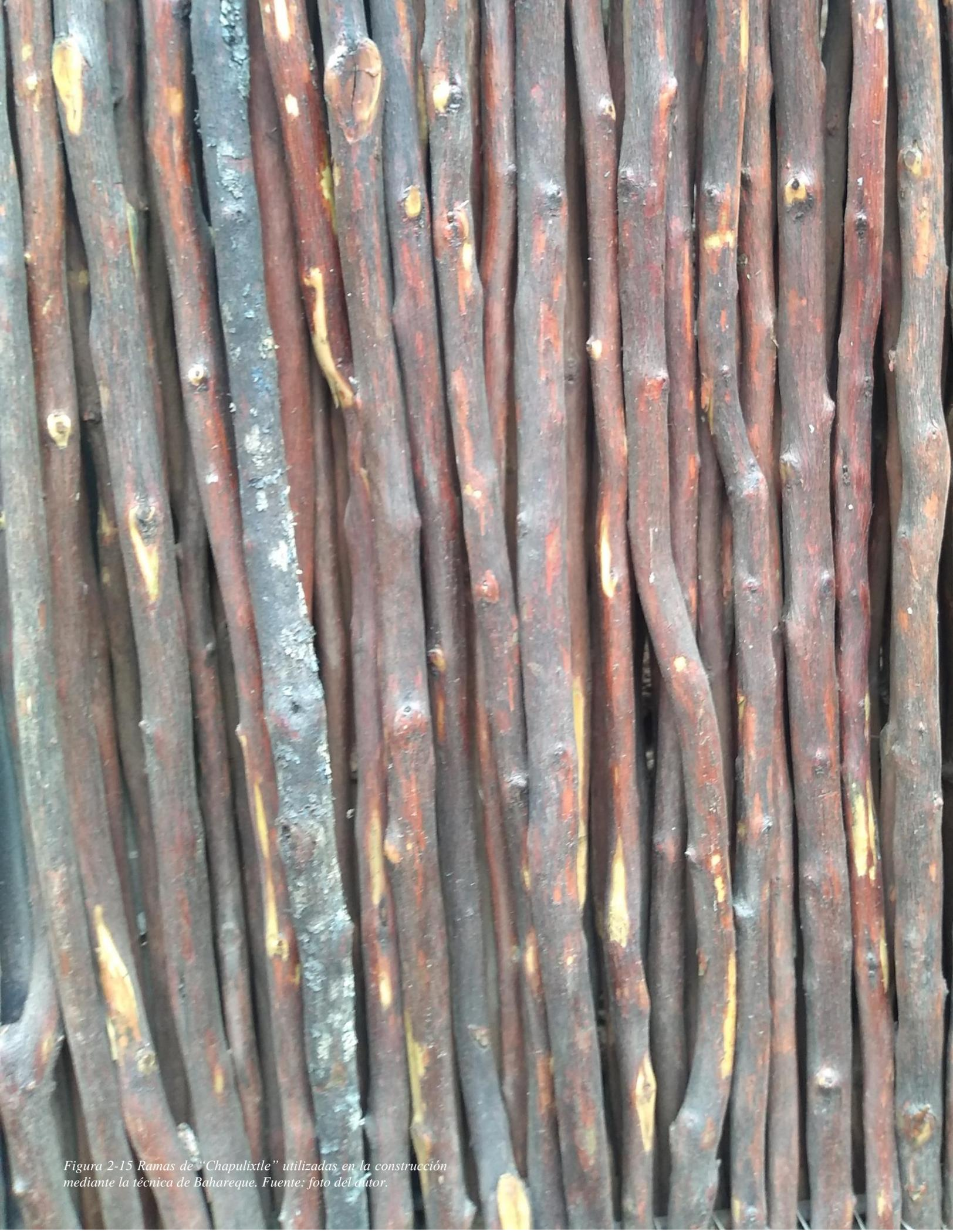
*Figura 2-15 Ramas de "Chapulixtle" utilizadas en la construcción mediante la técnica de Bahareque. Fuente: foto del autor.*
