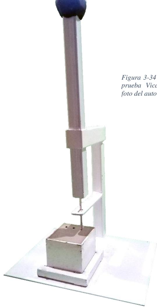
Figura 3-34 Ensayo de prueba Vicat. Fuente: foto del autor.
